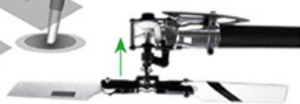
Use rudder stick to move the servo to the maximum allowed deflection 利用尾舵搖桿來移動伺服器，使其達到尾舵的最大容許偏轉率。
